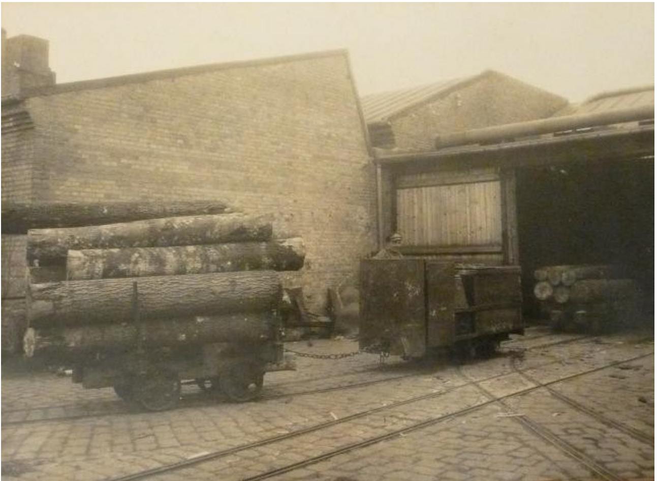
De specielle små og smalsporede tendervogne, der senere overtog hestenes arbejde med at trække vognene ind.
