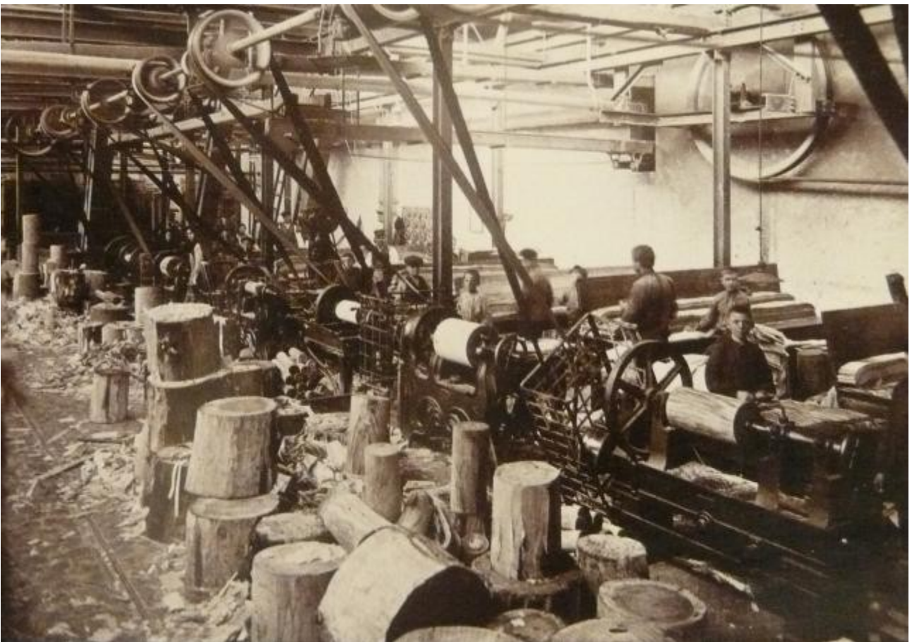
Blokkene drejes til spåner / finerer
